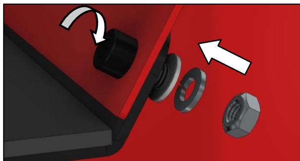
fig. 18 – boulonnage du support outils
