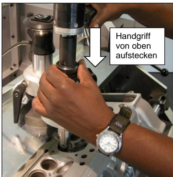
Abb. 34 - Aufstecken auf Drehadapter VGX-21
