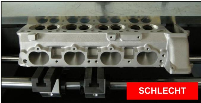
Abb. 31 - Zylinderkopf ist ungleichmässig abgestützt
